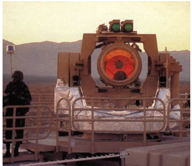
Тактический химический лазер. На испытаниях сбивает небольшие прямолетящие цели на высоте до 5 км
